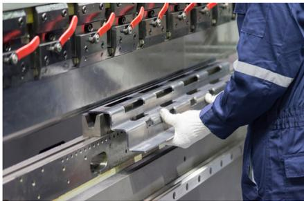
Abb. 116.3 Biegen eines Profils
