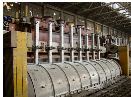
Abb. 125.1 Schmelzflusselektrolyse Aluminium
