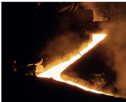
Abb. 122.2 Hochofenschlacke wird zur Herstellung von Zement und Beton verwendet
