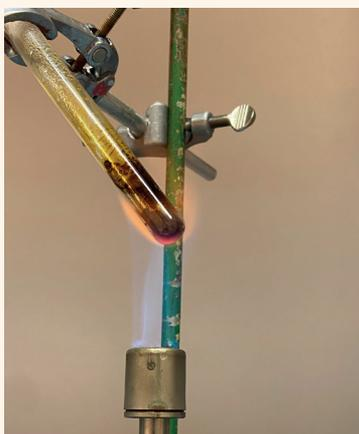
Abb. 122.3 Reduktion von Eisenerz
