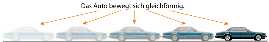
Abb. 12.1 Die Position des Fahrzeugs ist nach jeweils gleichen Zeitabschnitten dargestellt.
