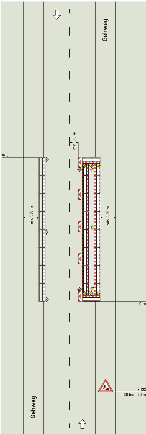
Regelplan B I/3 für 2-streifige Fahrbahn mit geringer Einengung
