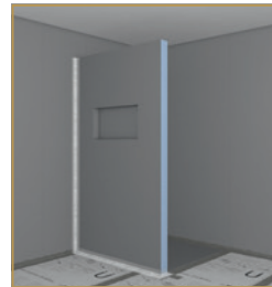
Abb. 4 Stöße mit Armierband verkleben
