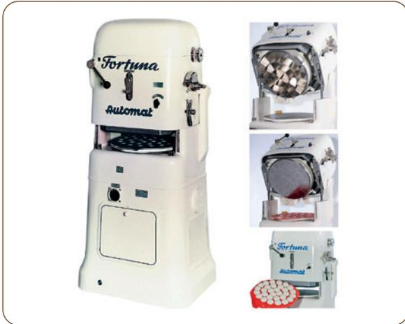
Teigteil- und Schleifmaschine (Wirkmaschine)
