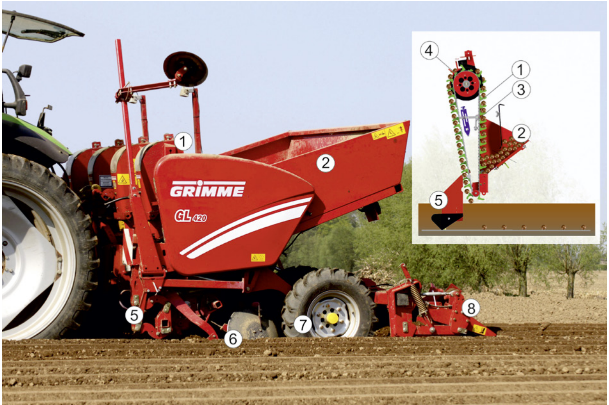
1 Becherlegemaschine – Anordnung der Baugruppen und Arbeitsweise
