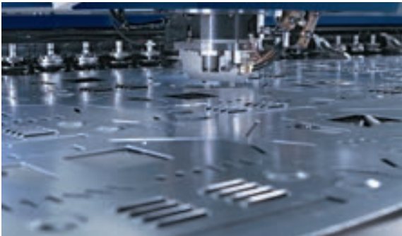
2 Kiemen eines Verkleidungsbleches
