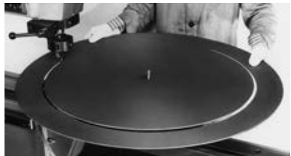
5 Gratfreies Schlitzen eines Blechringes
