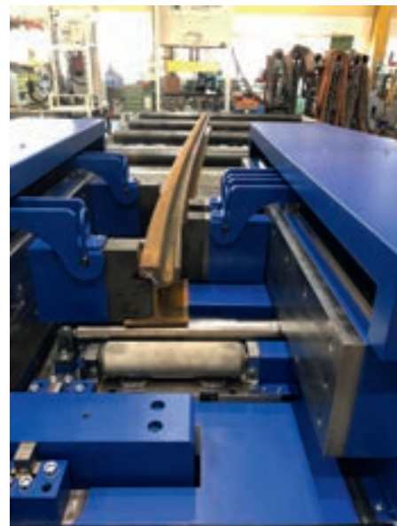
2 Richten einer Schiene
