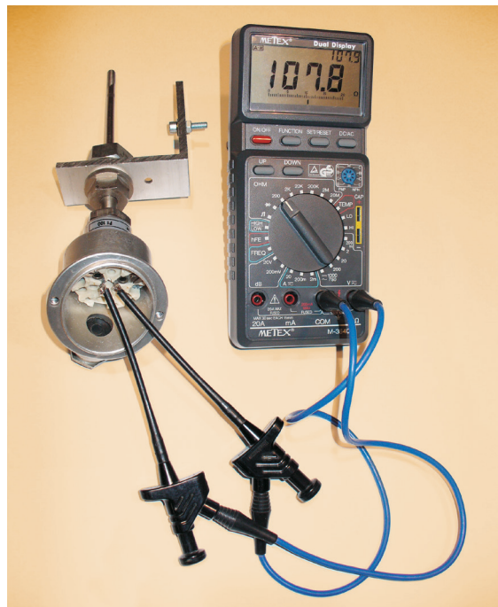
1 Ermittlung des Widerstandswertes eines Temperaturfühlers
