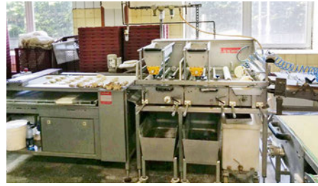
die Brötchenstraße mit Kopfmaschine / die Brötchenstraßen mit Kopfmaschinen bun line
