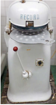
die Brötchenpresse, Schleifmaschine mit Wirkteller / die Brötchenpressen, Schleifmaschinen mit Wirktellern divider rounder with moulding plate
