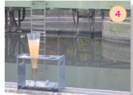
4 Vorklärbecken: Schwebende Teilchen sinken nach unten und werden in den Faulurturm abgesaugt.
