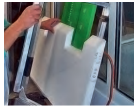
1. Schneiden mit EPS-Schneidegerät
