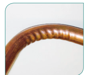
5 Faltenbildung bei einem gebogenen Cu-Rohr
