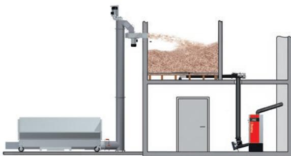
Abb. 18: Einbringung durch senkrechte Schnecke
