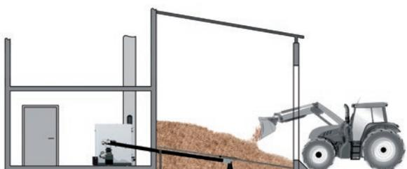
Abb. 19: Ohne Zwischenboden, Traktorbeschickung
