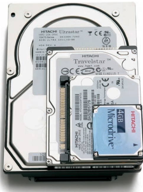
Abb. 1.32 Standardmaße für moderne Festplatten 3,5", 2,5", 1,8" und 1"
