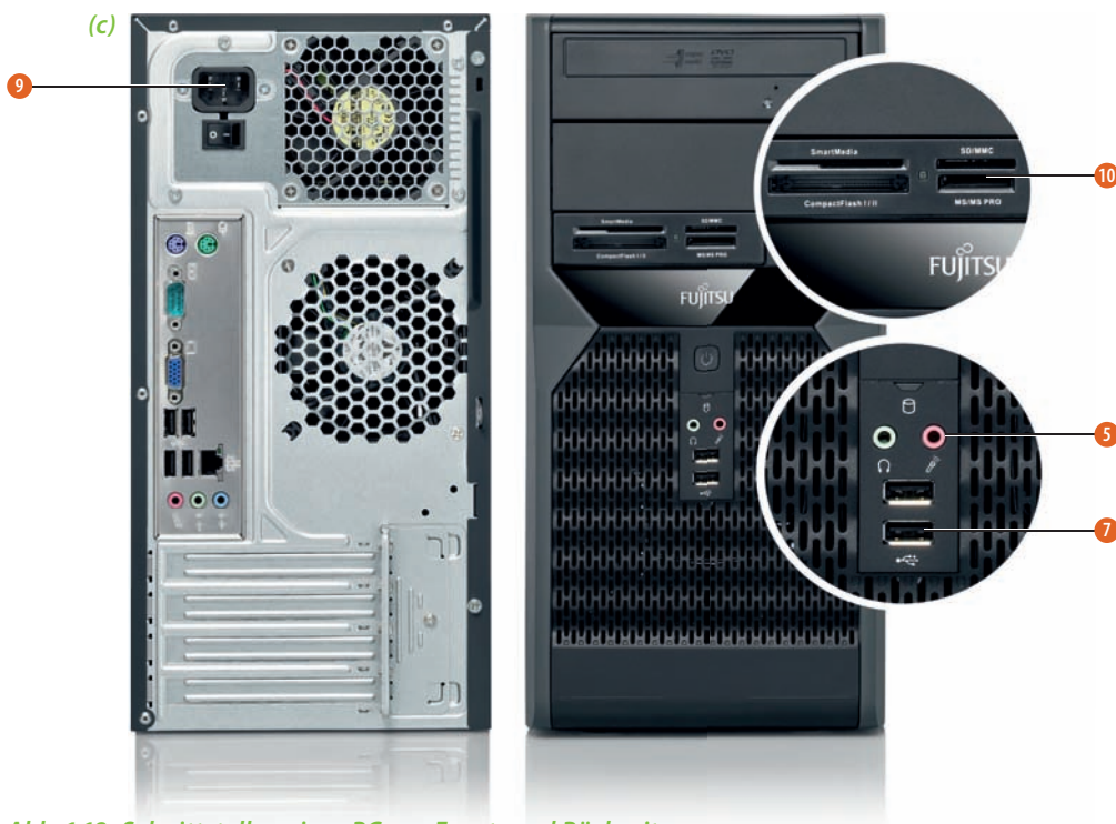
Abb. 1.18 Schnittstellen eines PCs an Front- und Rückseite
