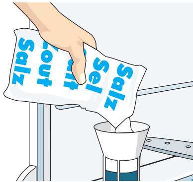
Salz mit Einfülltrichter in den Vorratsbehälter füllen
