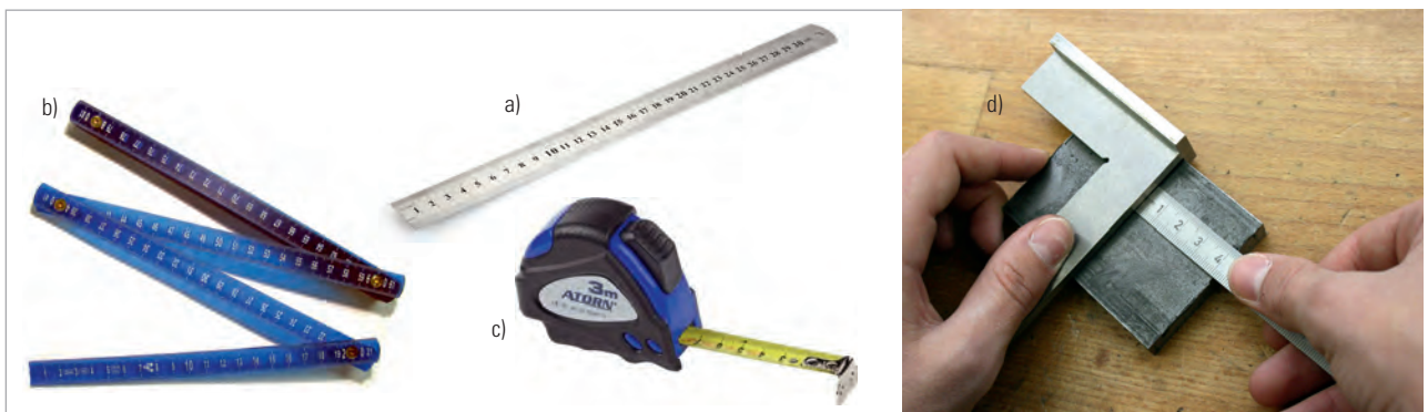
Bild 2 Stahlbandmaß (a), Messen mit dem Stahlbandmaß (d), Gliedermaßstab (b) und Rollbandmaß (c)
