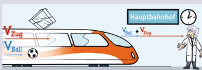
Abb. 102.3 Klassisches Geschwindigkeitsadditionstheorem : Ein Fußball fliegt im fahrenden Zug in Fahrtrichtung. Die Geschwindigkeit des Balls kann vom Bahnsteig aus als Summe der Zuggeschwindigkeit und der Geschwindigkeit des Balls beobachtet werden: \vec{v}_{\text{Beobachter}} = \vec{v}_{\text{Ball}} + \vec{v}_{\text{Zug}}
