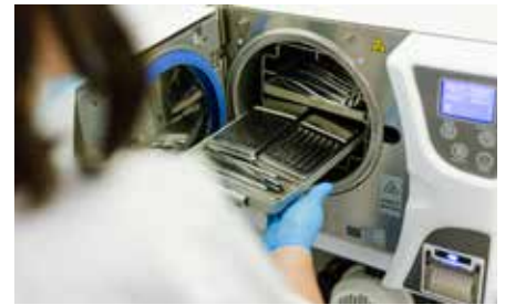
Abb. 85.1 Beladung eines Autoklaven für die Dampfsterilisation von Gegenständen
