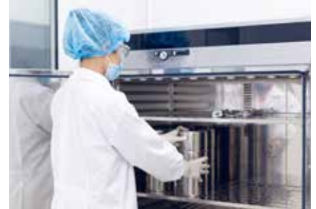
Abb. 85.2 Vorbereitung einer Heißluftsterilisation
