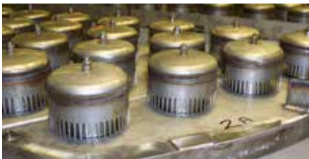
Abb. 101.3 Ausschnitt aus einem Glockenboden
