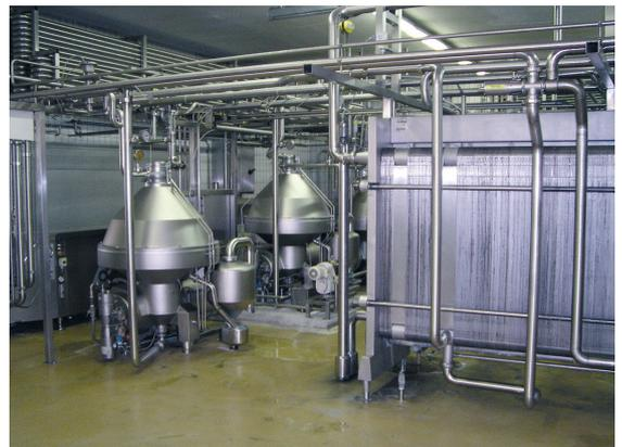
Abb. 2.58 Molkerei – Zentrifugen und Plattenpasteurisierung
