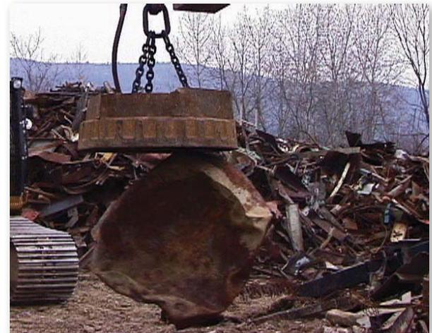
Abb. 22 Elektromagnet zum Heben von Eisenschrott
