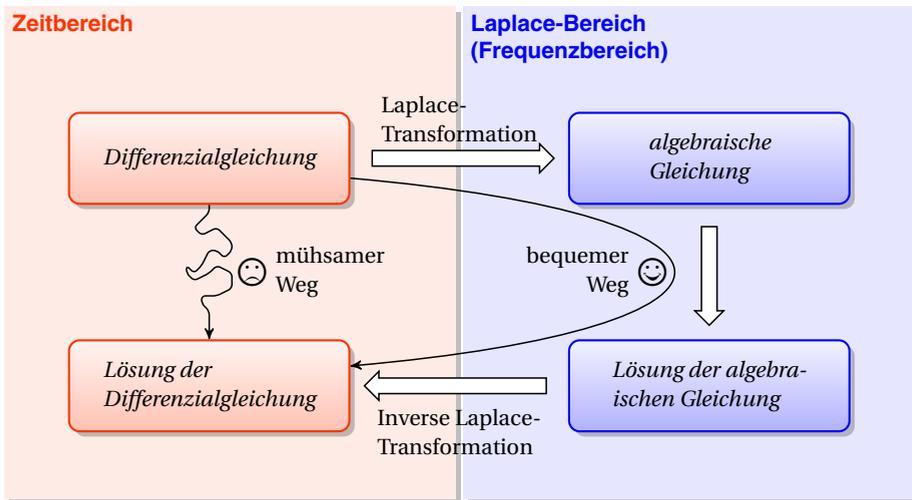
**Bild 1.7** Lösung einer Differentialgleichung mit Hilfe der Laplace-Transformation
