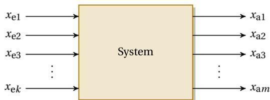
**Bild 1.1** Dynamisches System mit  $k$  Eingangsgrößen und  $m$  Ausgangsgrößen
