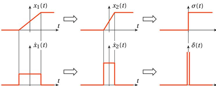
**Bild 1.12** Entstehung von Sprungfunktion und Stoßfunktion aus einer Rampe und deren Ableitung
